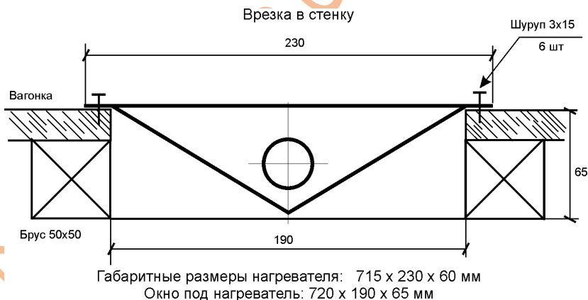
Рис.8 Установка тылового нагревателя (вид сверху)
